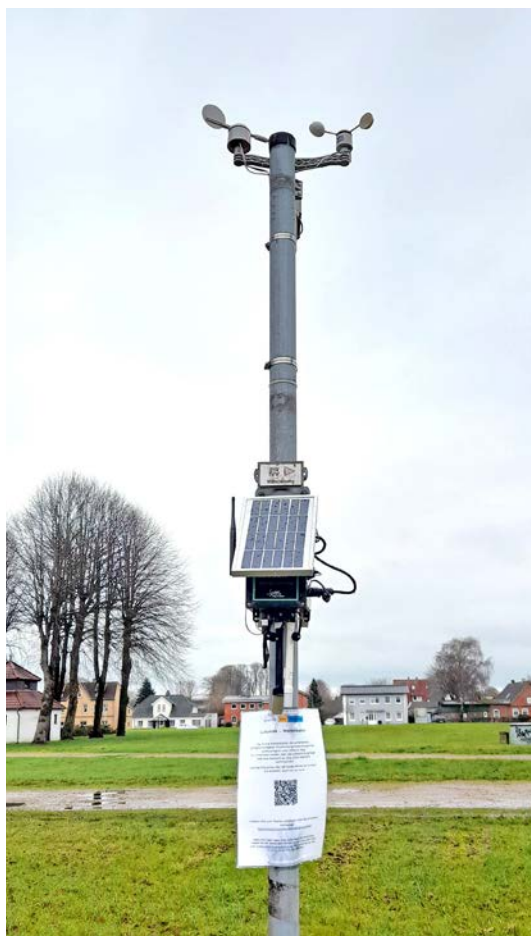
LoRaWAN- Wetterstation vorm Smarten Dörpshus, die Daten sind online öffentlich verfügbar.
