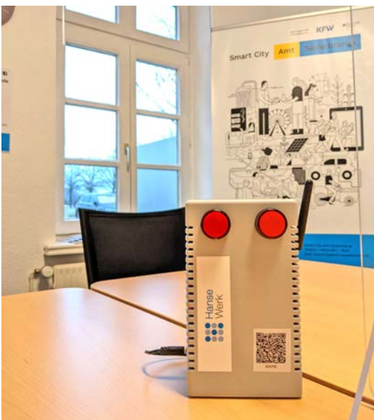
CO 2 -Sensor im Smarten Dörpshus, eingebunden in das LoRaWAN.
