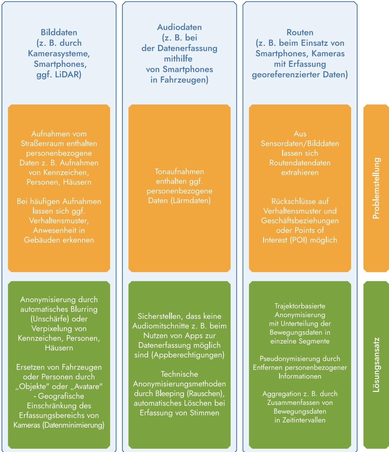
Abbildung 6: Beispiele für Anonymisierungsmöglichkeiten beim Einsatz von Sensorik an Fahrzeugen
